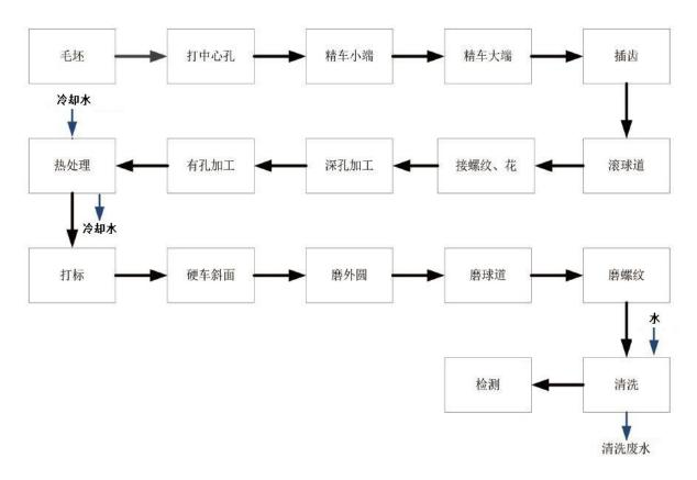
图 3-3 CVT 带轴类工艺流程图
