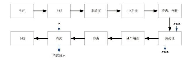
图 3-5 CVT 齿轮类零件生产工艺流程
