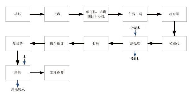
图 3-4 CVT 压板类零件工艺流程
