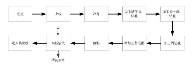
图 3-7 CVT 阀体生产工艺流程
