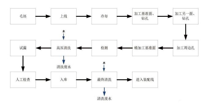
图 3-6 CVT 壳体生产工艺流程
